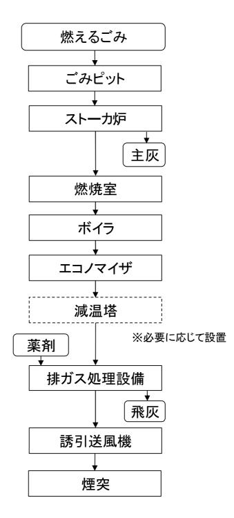
図5-3 ごみ焼却施設の基本処理フロー
