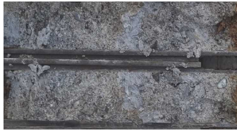
B-2 孔の標準貫入試験試料写真 (GL-3.15~3.45m) 火山灰質粘性土
