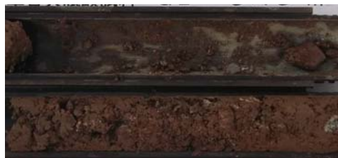
B-2 孔の標準貫入試験試料写真 (GL-6.15～6.47m) 粘土質砂礫
