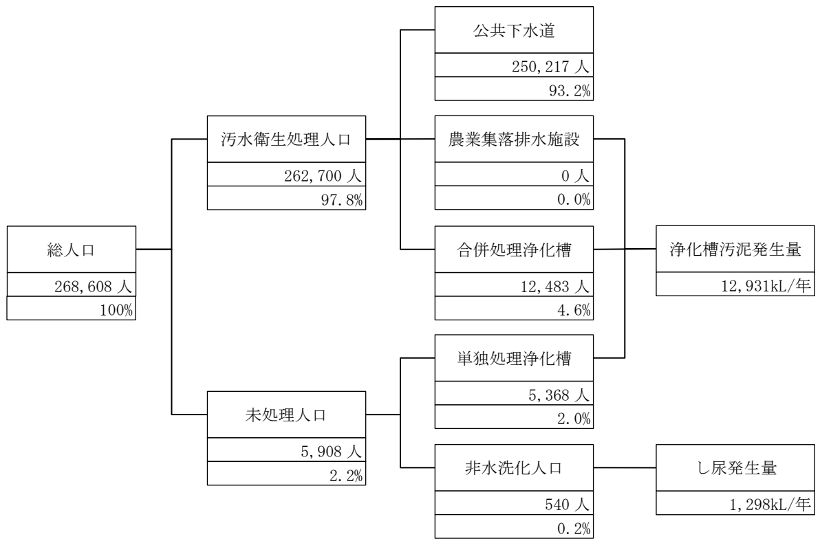
図4 目標達成時の生活排水の処理状況フロー（令和8年度）
